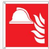
Attrezzature antincendio F004
